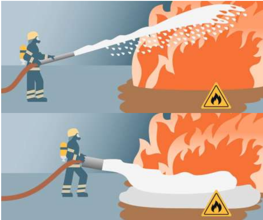
Abb. 24: Indirekte Applikation von Löschschaum durch Abregnen
