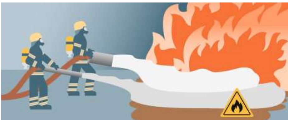
Abb. 26: Indirekte Applikation von Löschschaum durch kombiniertes Aufschieben
