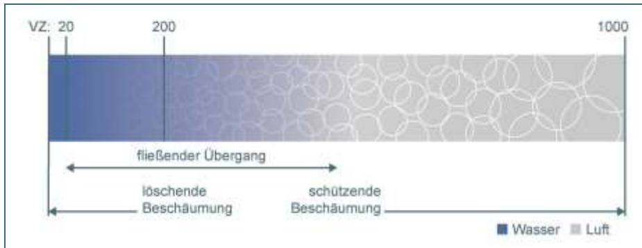
Abb. 7: Funktion der Beschäumung in Abhängigkeit von der VZ
