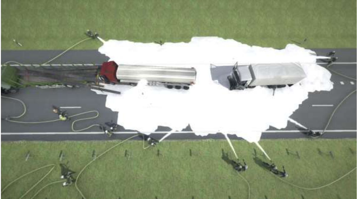
Abb. 29g: Fünfter Schritt – Geschlossene Schaumdecke:
