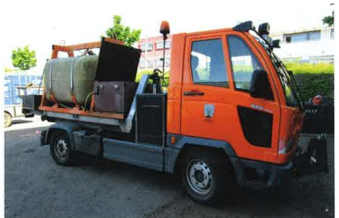
▲ Abb. 17.a: WLF „klein“ mit AB zur Bewässerung auf einem kleinen Fahrgestell mit Straßenantrieb können trotzdem zur Unterstützung der Brandbekämpfung sinnvoll sein, wenn es z.B. darum geht, über befestigte, aber sehr schmale Zuwegungen, z.B. in großflächigen Kleingartenanlagen oder Friedhöfen, abgelegene Bereiche anfahren zu können. Besser ist es natürlich, auch hier mit Einsatzfahrzeugen befahrbare Wege zu haben.
