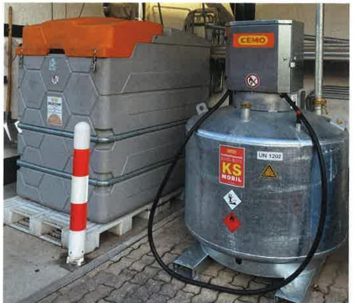
▲ Abb. 20.a und b: Im Bedarfsfall mobile Betriebsstofftankstellen für Diesel und Benzin (auch für mobile Aggregate) ermöglichen auch die autarke Versorgung.
