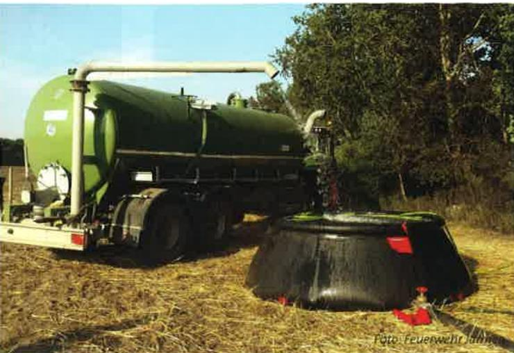
▲ Abb. 8: Moderne Güllefässer haben Dimensionen im LKW-Bereich! Einige dieser Anlagen haben auch einen ausschwenkbaren Galgen zum Befüllen von Wasserbehältern.
