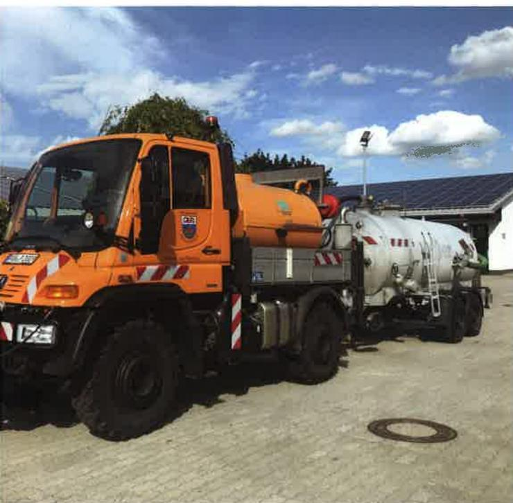
Mit dem „Grünflächen-Unimog“ mit aus der Kabine fernsteuerbarem Gießgalgen, kann das Ablöschen von Feuersäumen natürlich beschleunigt werden. Geeignetes manuelles Gerät sollte trotzdem über die Feuerwehren mitgeführt und eingesetzt werden, um auch unzugänglichere Bereiche leicht und schnell ablöschen zu können.
