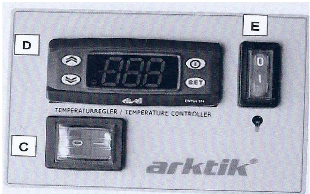
Das Gerät verfügt über einen elektronischen Digitalthermostat (D); zur Einstellung des Sollwertes der Betriebstemperatur lesen Sie die dazugehörige Betriebsanleitung.
